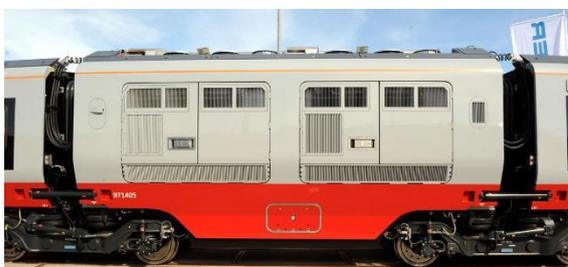
Abb. 2-13 Unterbringung der Komponenten der zweiten Traktionsart in weiterem Wagenkasten
