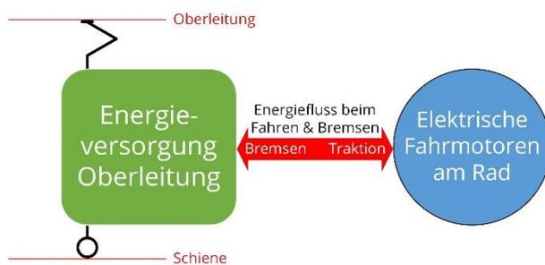
Abb. 2-4 Antriebsstrang klassischer elektrischer Elektrotriebzug (schematisch)
