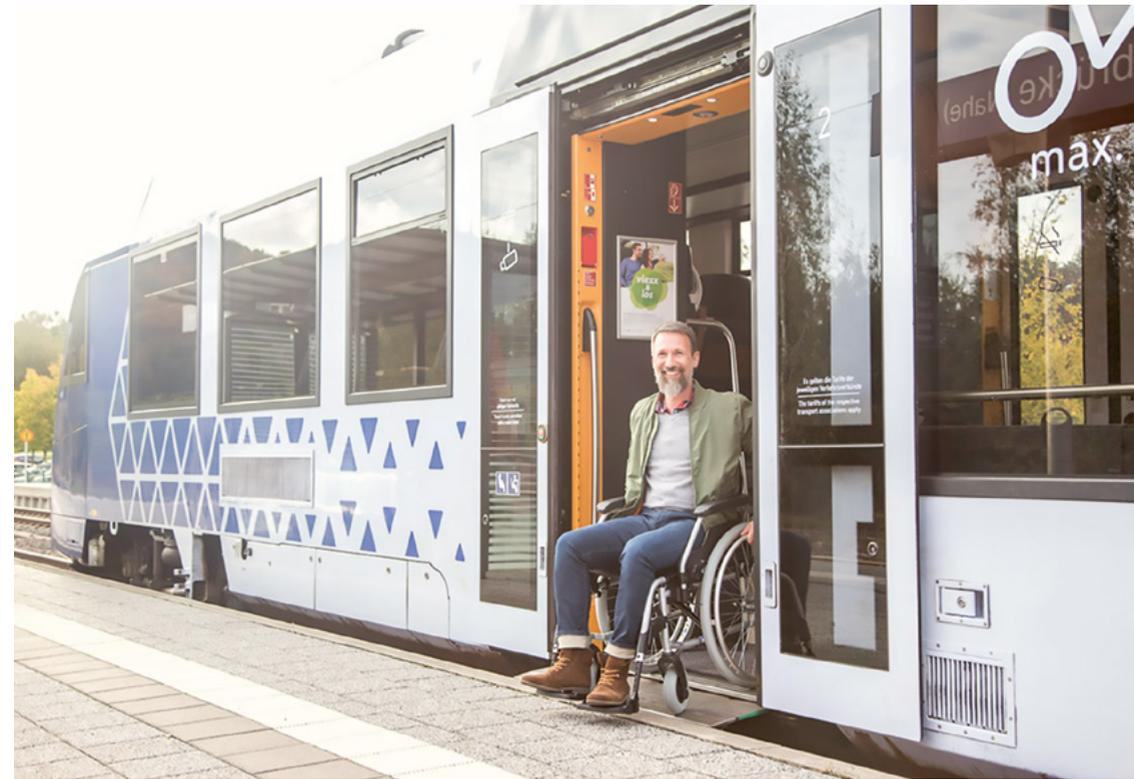
Ebenerdiger Ausstieg mit Spaltüberbrückung auf der Nahestrecke.
