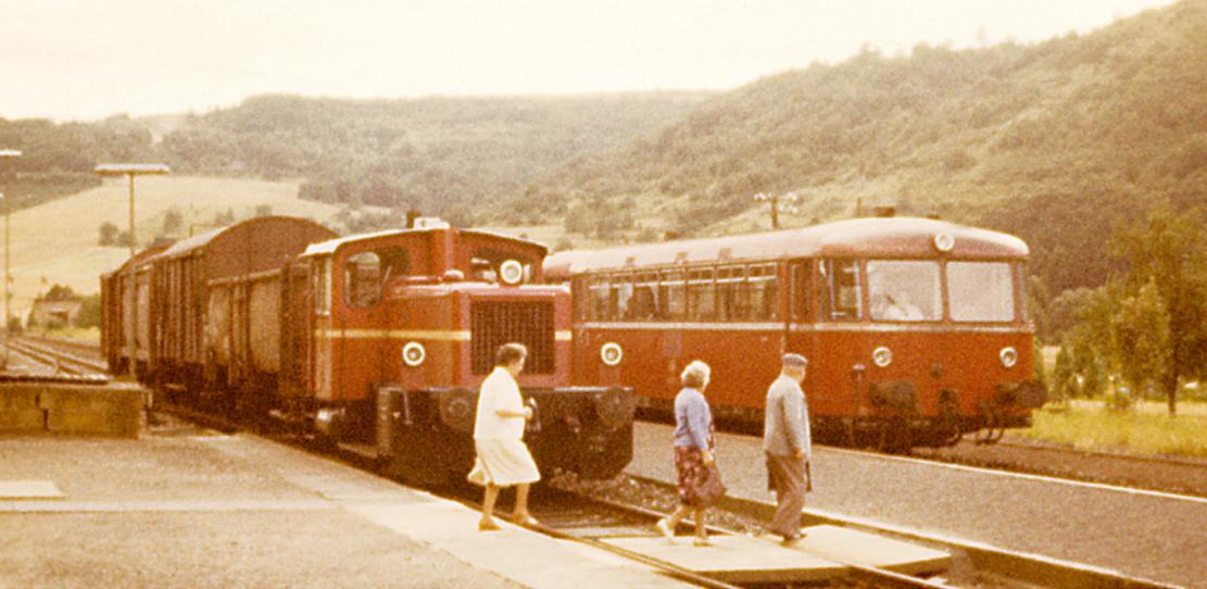
Viele Jahre prägten Schienenbusse den Verkehr im Glantal. Den Güterverkehr nach Odernheim beförderte die Bahn 1978 mit einer sog. Köf III. Im Hintergrund ist der frühere Lokschuppen zu erkennen.
